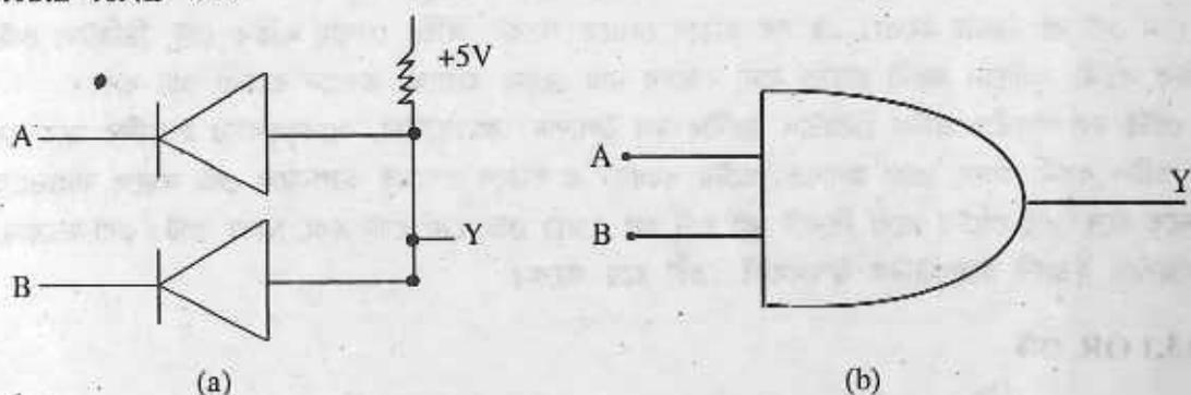
চিত্র 8.13.2 : এই ইনপুটযুক্ত AND গেট (a) গঠন (b) সংকেত
