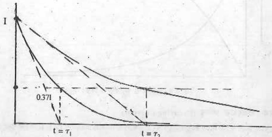
চিত্র 6.8 : ক্ষয়িত প্রবাহমাত্রা
