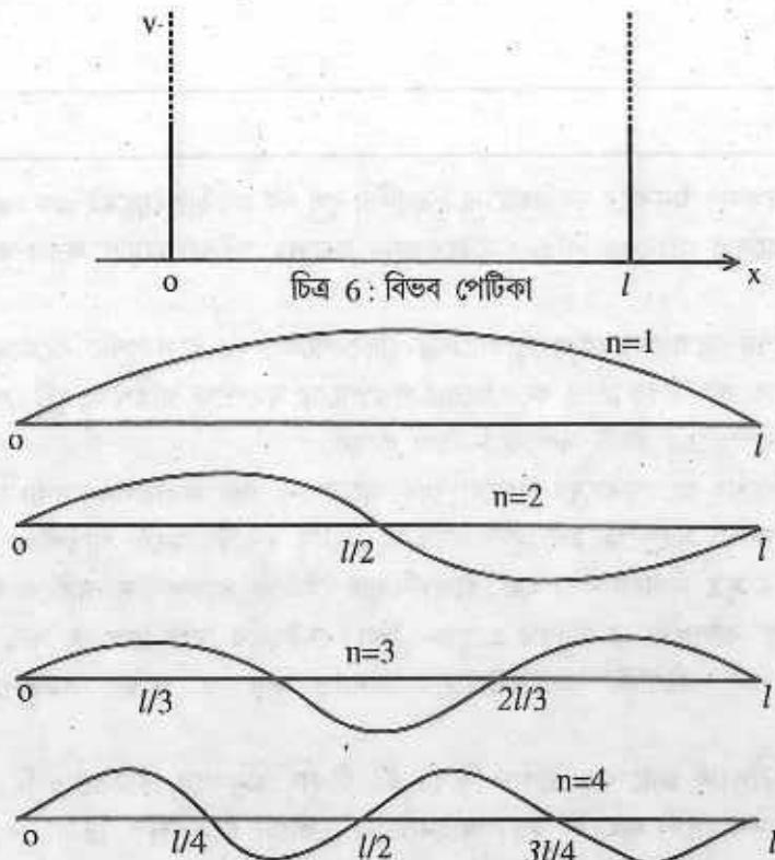
চিত্র 6a: একমাত্রিক বিভব পোটিকার ক্ষেত্রে তাৎক্ষণিক তরঙ্গ অপোককগুলি
