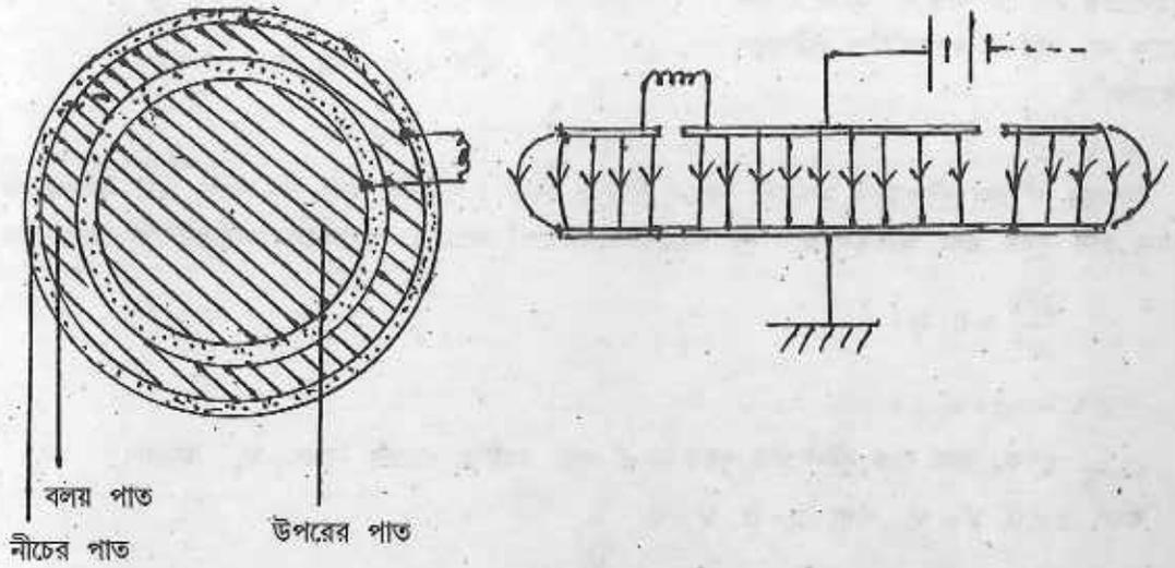
চিত্র 4.20 রক্ষী-বলয় ধারক (Guarding Capacitor)
