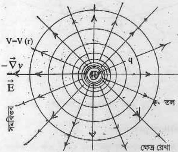
চিত্র 4.9  $V$  ক্ষেত্রে ও  $\vec{E}$  ক্ষেত্র
