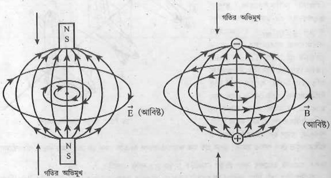
চিত্র 3.1: (a) পরিবর্তনশীল  $\vec{B}$  ক্ষেত্র আবিষ্ট করে  $\vec{E}$ -ক্ষেত্র
